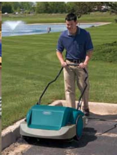
Максимальная производительность двойные боковые щетки обеспечивают ширину прометания 870 мм, а бак 50-литрового объема вмещает больше мусора, что позволяет сэкономить время для уборки.
