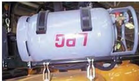
(ii) Вверните фиксирующую рукоятку кронштейна цилиндра в крепежное отверстие, чтобы предотвратить его вращение.
