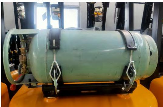
(1) Топливная система для сжиженного газа используется для сжиженного нефтяного газа и двухтопливных вилочных погрузчиков. В основном он состоит из стального кронштейна для баллона, баллона для сжиженного газа и устройства для преобразования топлива. Баллон со сжиженным газом устанавливается на
