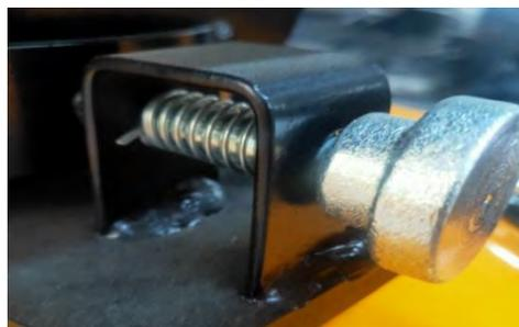
(iii) Зафиксируйте монтажную скобу кронштейна баллона, а затем установите все соединения и газовую трубу высокого давления.
