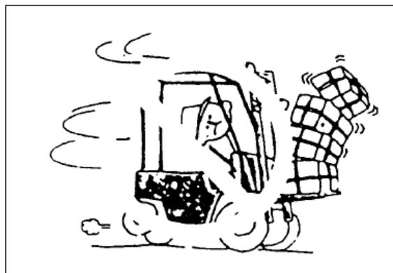
27. Наклон назад при нагрузке. Перемещайтесь с грузом как можно ниже и с наклоном назад. При работе со стальными поддонами обязательно откиньте мачту назад, чтобы она не соскользнула с вил.
