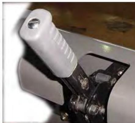
Используйте рычаг стояночного тормоза, чтобы поставить погрузчик на стоянку. Стояночные тормоза включаются на двух передних колесах, если потянуть за этот рычаг вверх. Чтобы отпустить стояночный тормоз, переместите рычаг вперед.
