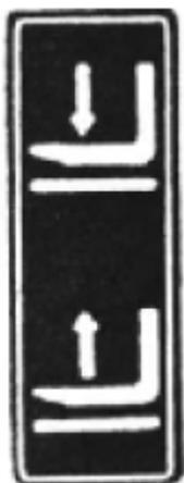
Вилы можно поднять или опустить, потянув назад или нажав на рычаг. Скорость подъема регулируется углом наклона рычага назад и нажатием на педаль акселератора, а скорость опускания - углом наклона рычага вперед. Скорость вращения двигателя или педали газа не имеет отношения к скорости опускания вилок.
