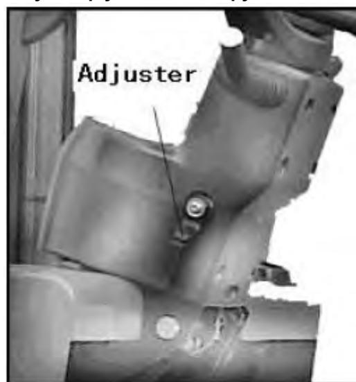
Угол наклона рулевой колонки регулируется в диапазоне 12,5 градусов в зависимости от индивидуальных особенностей оператора. Рулевая колонка разблокируется поворотом рычага регулятора против часовой стрелки и блокируется поворотом по часовой стрелке.
