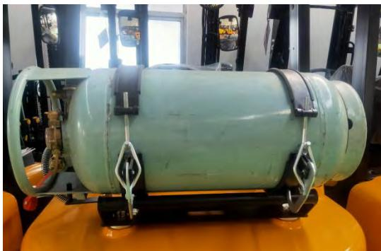
(1) Топливная система для сжиженного газа используется для сжиженного нефтяного газа и двухтопливных вилочных погрузчиков. В основном он состоит из стального кронштейна для баллона, баллона для сжиженного газа и устройства для преобразования топлива. Баллон со сжиженным газом устанавливается на
